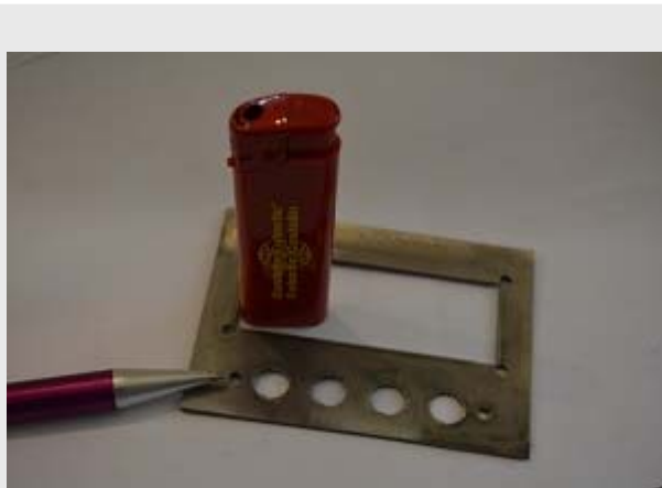
Деталь на плазме Metal Master CUT CNC 6
