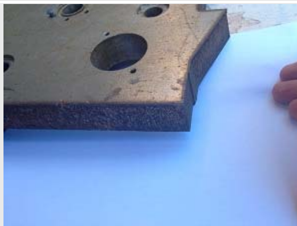
Резка нержавеющей стали толщиной 32 мм на установке
